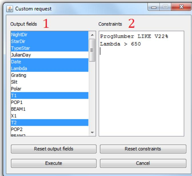
Utilisez la fenêtre de composition des requêtes personnalisées (figure ci-contre), accessible par le menu Custom Request de la barre de menus (marqueur 1 de l'interface utilisateur) et le raccourci clavier Ctrl+R.
